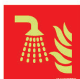
F011 Espacio protegido por agua nebulizada
