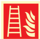
F003 Escalera de incendio
