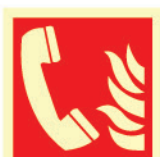
F006 Teléfono de emergencia
